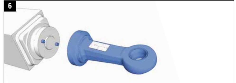
Zugöse mit Typenschild nach oben montieren. Fit drawbar eye with nameplate facing upward.
